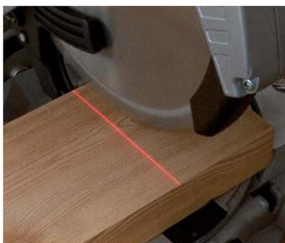
Dotata di laser di precisione per facilitare il taglio. Attivazione automatica dello stesso, all'accensione della macchina. Include interruttore on/off, ideale per disattivarlo nei lavori su piano superiore.
